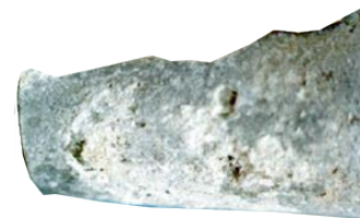
Blocco di alluminio corroso da corrente galvanica
